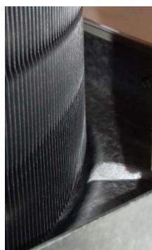
CSATORNASZERŰ KIALAKÍTÁS A CSEPPTÁLCABA INTEGRÁLT KONDENZÁTOR SZÁMÁRA
