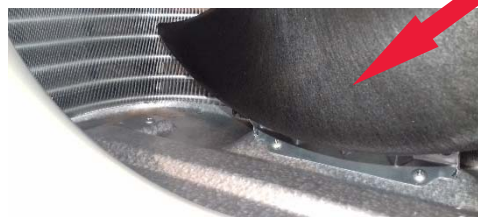
A KONDENZÁTOR VENTILÁTOR LAPÁTJA ALATTI KIEMELKEDÉS A CSEPPVÍZ TÁVOLTARTÁSÁT SZOLGÁLJA
